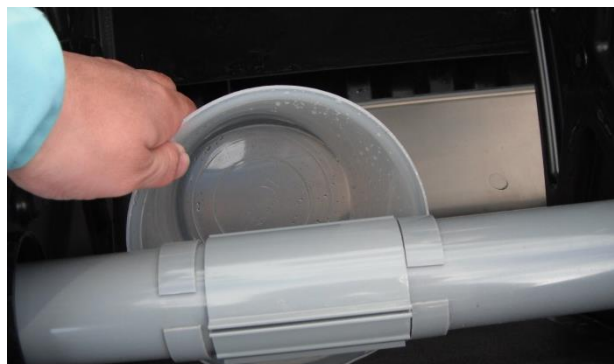
測定口より水量を測定
