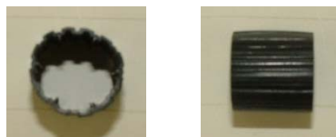
担体流動槽第二室担体の外観
