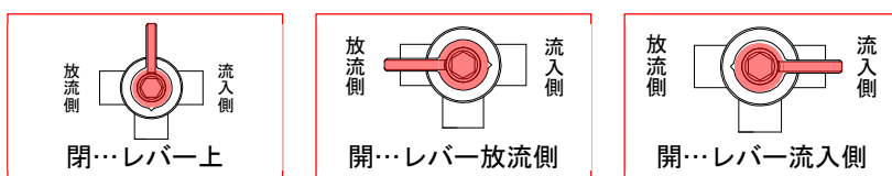
図 5、7人槽ろ材洗浄用バルブ（赤）操作
