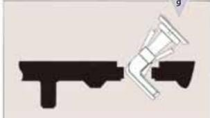
※ マンホールカバーの穴に、ロックを図のように差し込み強く押し込むとはまります。
