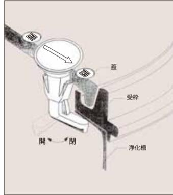
● ロック上部の↑マークを開に合わせるとロック下部が開の位置になり蓋が取り外せます。閉に合わせますとロック下部が閉の位置になり蓋が開けられなくなります。
