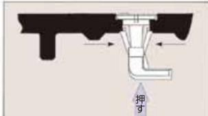
※ プライヤー等によりロックアンカー部を内側から矢印の方向にはさみ込み、指で、上方に押し上げればはずれます。
